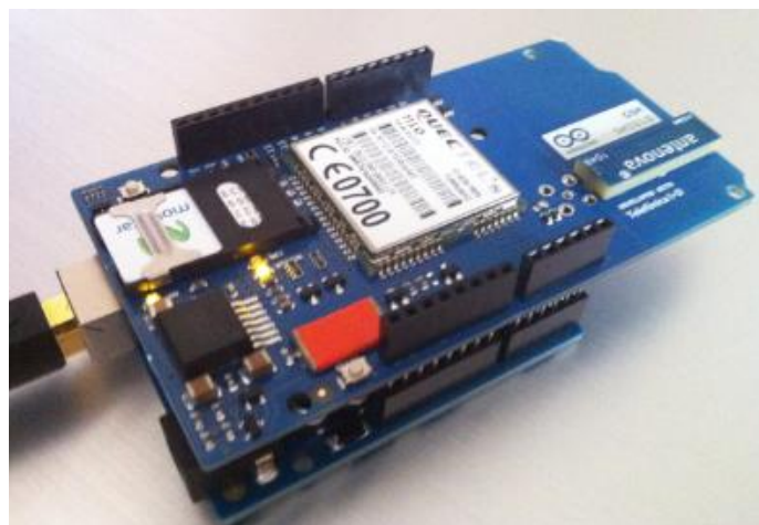
Figura 02 - Arduino com shield GPRS.
