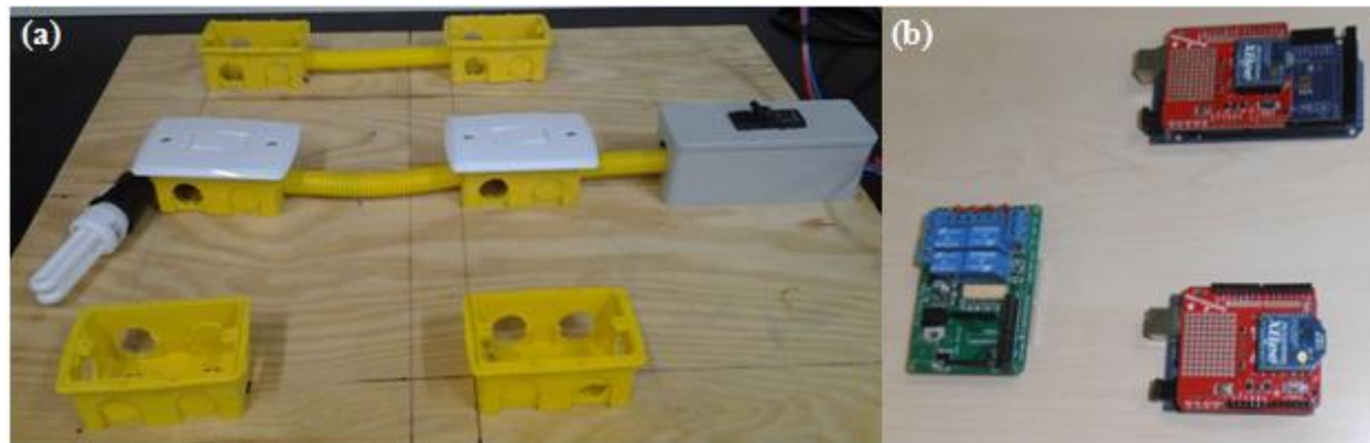
Figura 02 - (a) Painel elétrico com interruptores em paralelo. (b) Dispositivos utilizados na automação.
